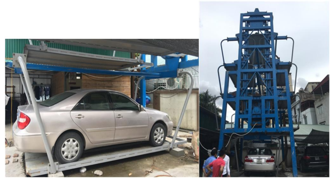
Hình 8. Thử nghiệm cabin nâng xe thực tế
