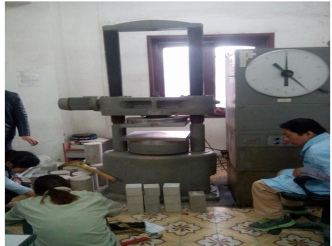
Hình 1. Hệ thống ép gạch ở áp lực 25 tấn
