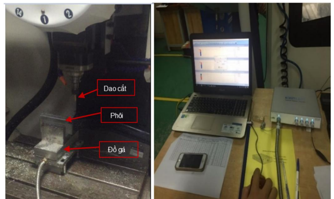
Hình 3. Thiết bị đo lực cắt và đồ thị kết quả đo
