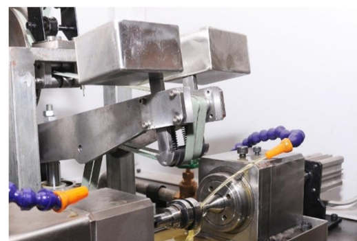
Hình 2. (a) Sơ đồ bố trí thí nghiệm đánh bóng trục cam, (b) Thực nghiệm trên máy đánh bóng trục cam
