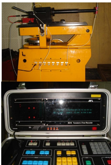
Hình 4. Hệ thống đo áp suất nòng súng K56 sử dụng bộ bản B299 và máy hiển thị B212
