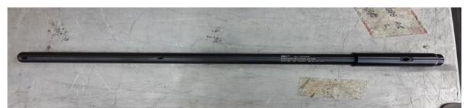
Hình 3. Nòng chuyên dùng và khóa nòng đo áp suất trong ống đạn K56
