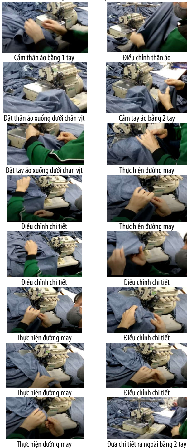
Hình 9. Hình ảnh minh họa phân tích quy trình thao tác may công đoạn tra tay
