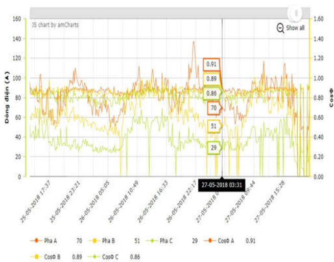
Hình 11. Thông số dòng điện và cosphi được giám sát
