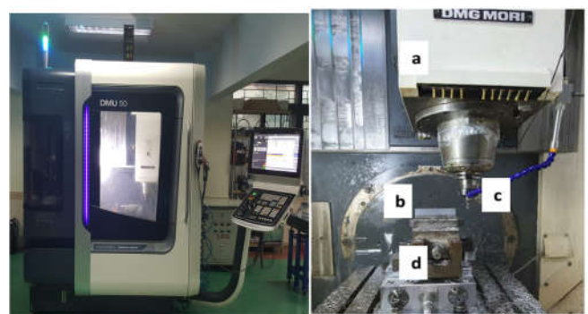
Hình 3. Trung tâm gia công CNC 5 trục DMG DMU50 và hệ thống gia công
