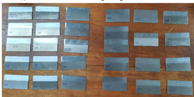
Hình 1. Mẫu thí nghiệm hợp kim nhôm A6061
